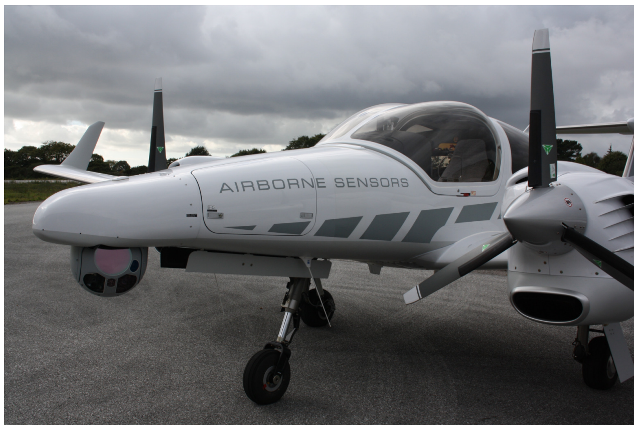
Fig 1 : DA42MPP équipé d'une "boule gyrostabilisée" avec caméras IR et Visible
