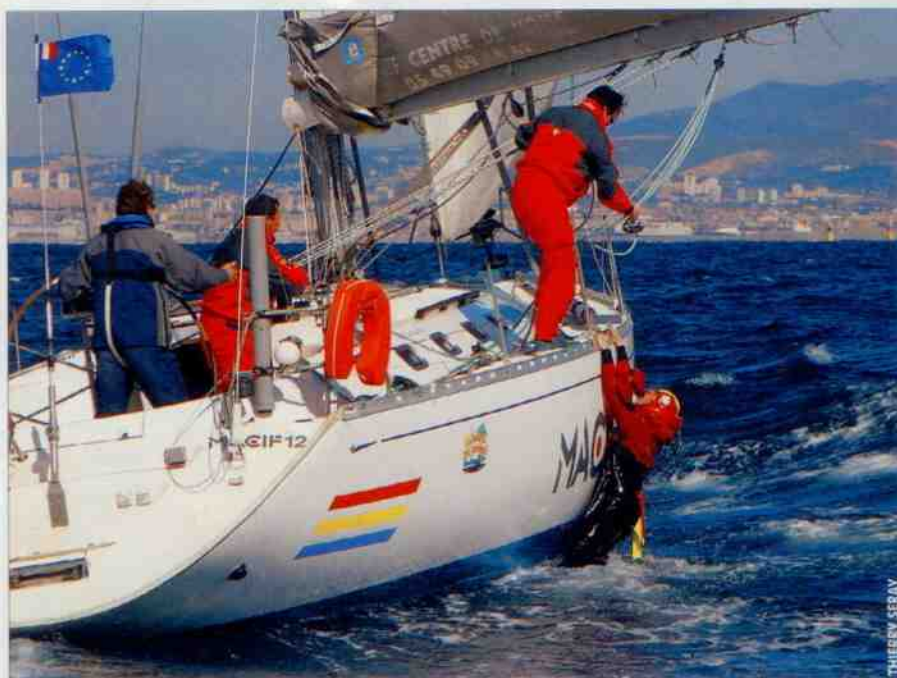
▲ Au fait, comment remonter la victime à bord? La drisse est souvent plus efficace que le palan, mais attention, si la personne est inconsciente, il faut en principe la remonter à l'horizontale.
