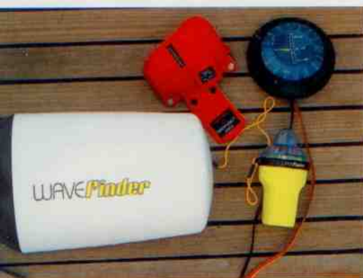
▲ Le système de gonio WaveFinder inclut une antenne omnidirectionnelle; à droite, l'émetteur (jaune) et sa housse (rouge), et le petit écran.
